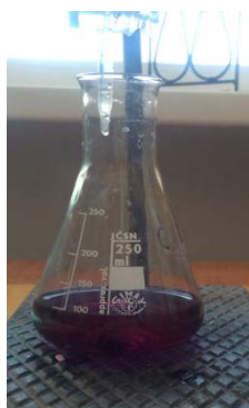
Рис. 2. Определение постоянной жесткости воды. Цвет индикатора эриохрома сине-черного до титрования раствором трилона Б (а) и после (б)
